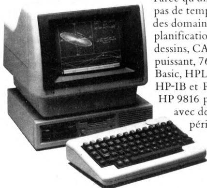
Parce qu'un chercheur, un ingénieur n'a pas de temps à perdre, HP 9816 couvre des domaines d'applications multiples : planification, ingénierie, tests, calculs, dessins, CAO, DAO... Compact, puissant, 768 Koctets, 16 bits, langages Basic, HPL ou Pascal, interfaces HP-IB et RS-232 C intégrés, HP 9816 peut dialoguer avec des centaines de périphériques.
